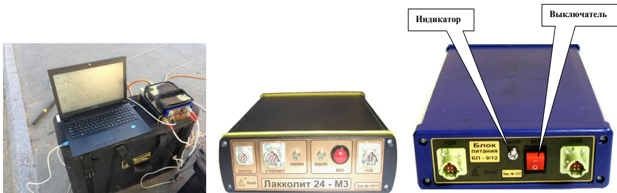
Şəkil 2.1. Lakkolit 24-M3 qurğusunun görünüşü
