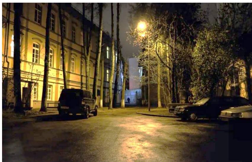
Рис. 3. Освещение прилегающей к дому территории. Система освещения создает паразитную засветку окон и причиняет им дискомфорт.
