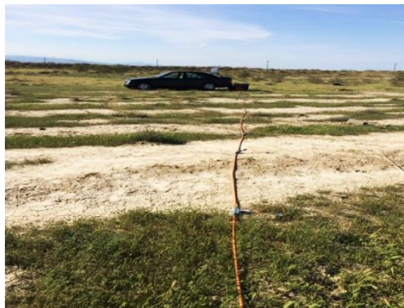
Şəkil 2.3. Lakkolit 24-M3 çox kanallı rəqəmsal mühəndisi seysmik kəşfiyyat stansiyası ilə sahədə iş zamanı
